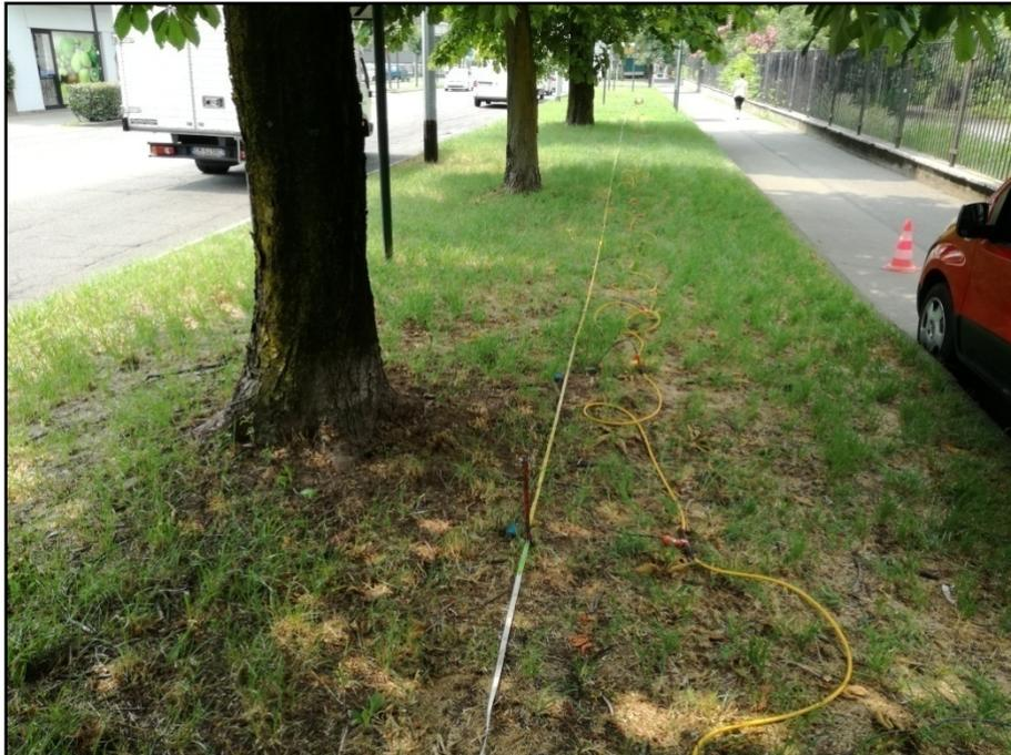
Figura 8.11: Vista dello stendimento MASW 5 – Area A5
