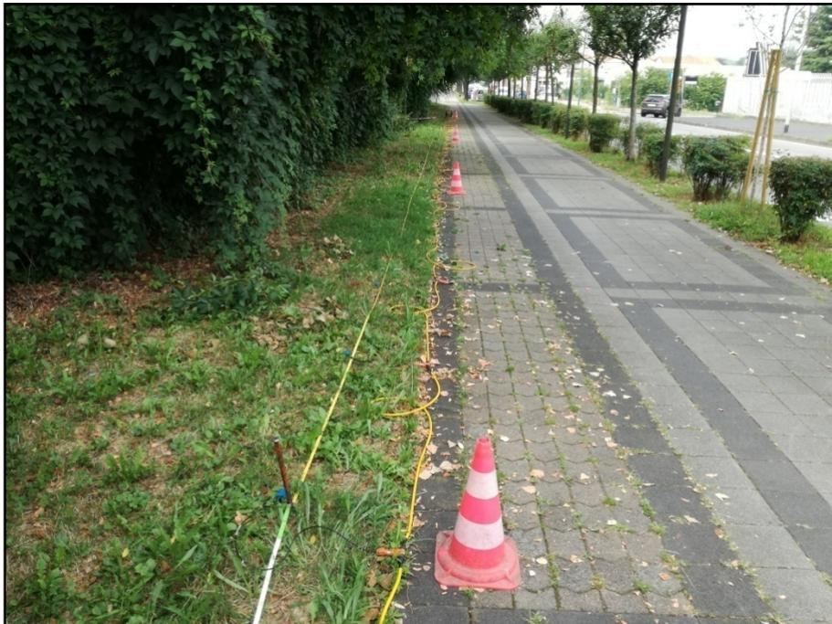
Figura 8.8: Vista dello stendimento MASW 2 – Area A2
