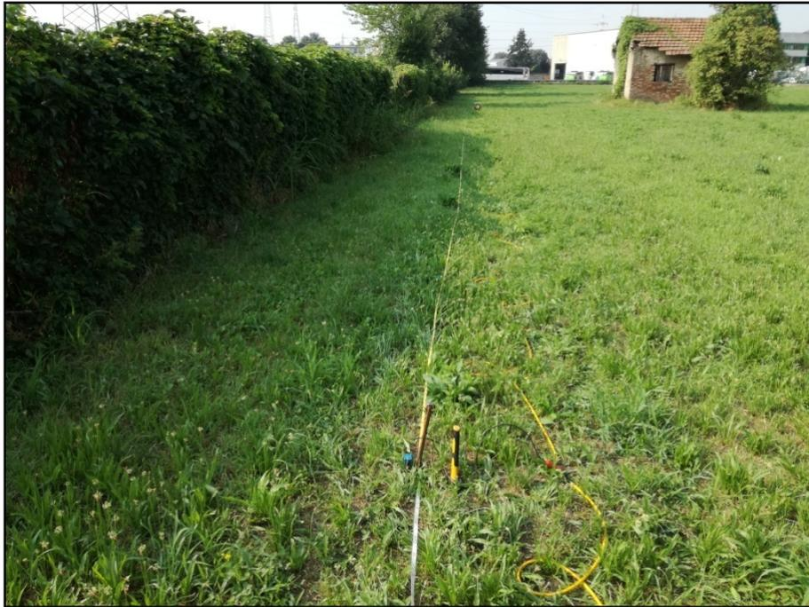
Figura 8.7: Vista dello stendimento MASW 1 – Area A1
