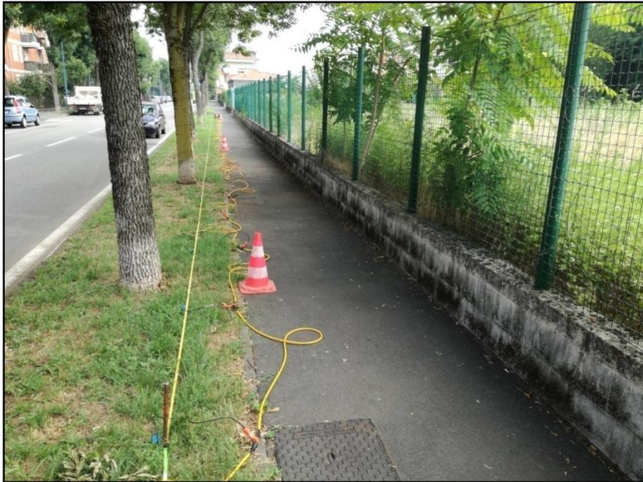
Figura 8.9: Vista dello stendimento MASW 3 – Area A3
