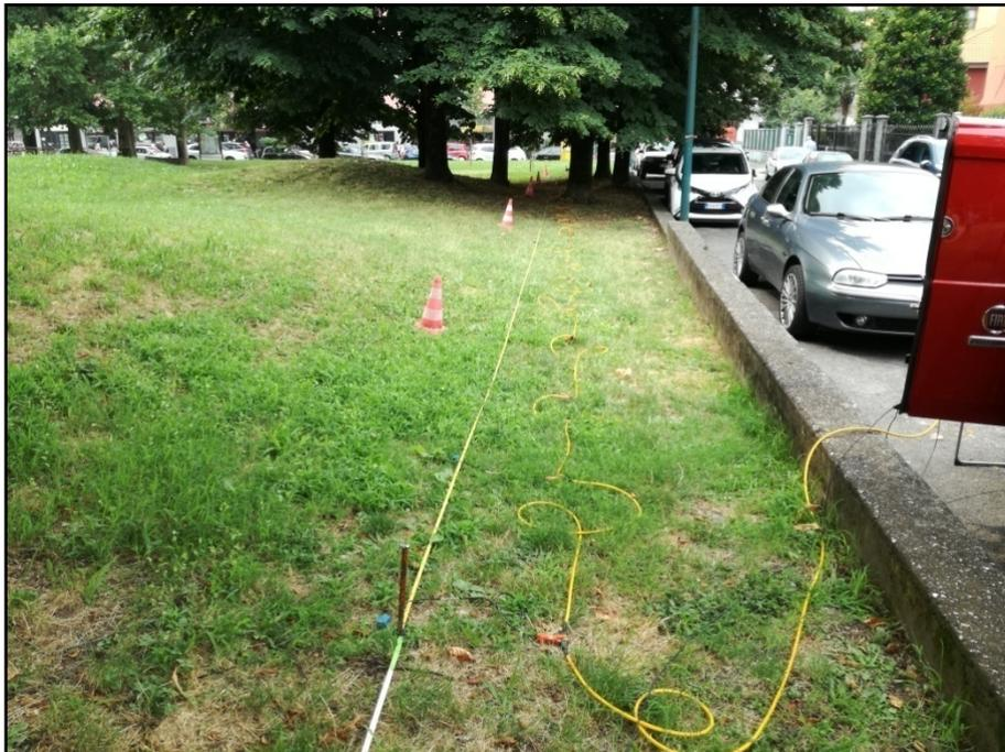
Figura 8.10: Vista dello stendimento MASW 4 – Area A4
