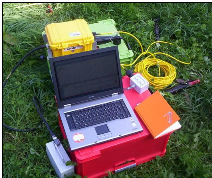
Figura 2: Strumentazione utilizzata per la prova MASW.
