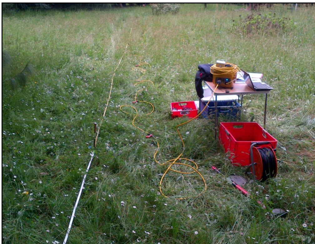
Figura 3: Vista dello stendimento MASW effettuato.
