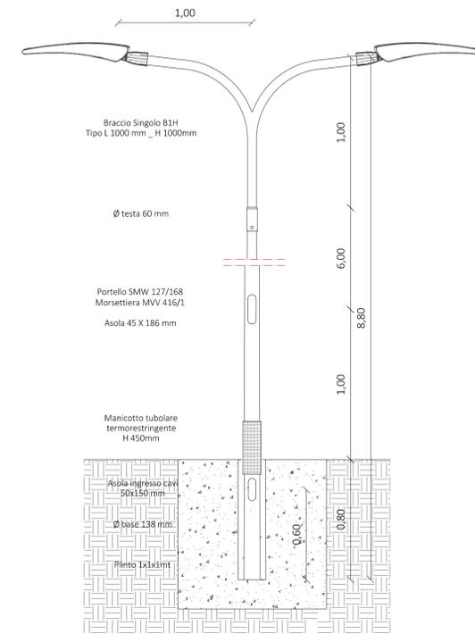
Dettaglio lampione Schreder Teceo 1 / 48 leds - 106W in scala 1:20 - attacco doppio - stradali
