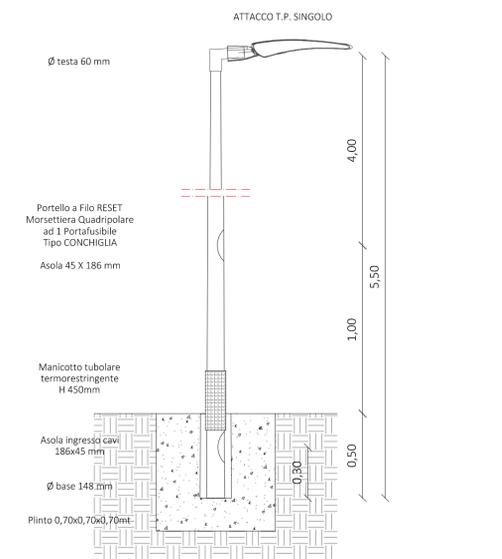
Dettaglio lampione Schreder Teceo 1 / 16 leds - 26W in scala 1:20
