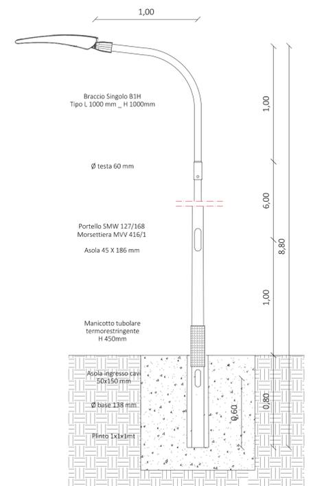
Dettaglio lampione Schreder Teceo 1 / 48 leds - 106W in scala 1:20 - attacco singolo - stradali
