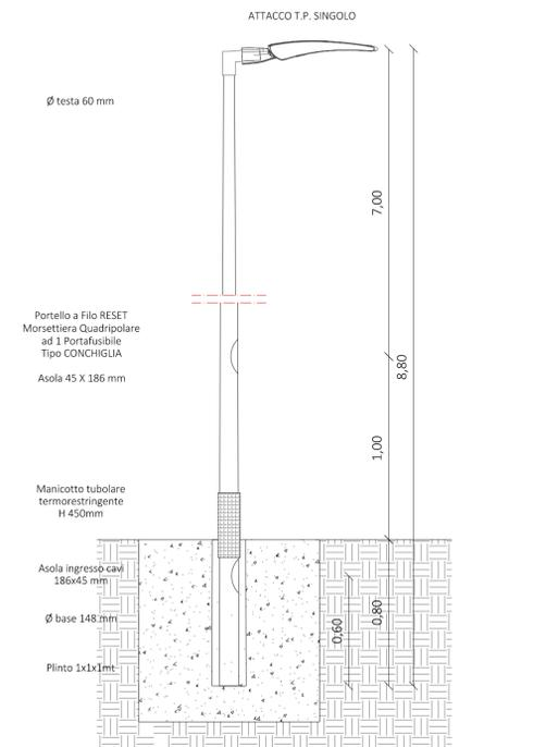
Dettaglio lampione Schreder Teceo 1 / 48 leds - 106W in scala 1:20 - parcheggi
