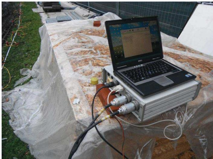
Strumentazione utilizzata per l’indagine sismica
